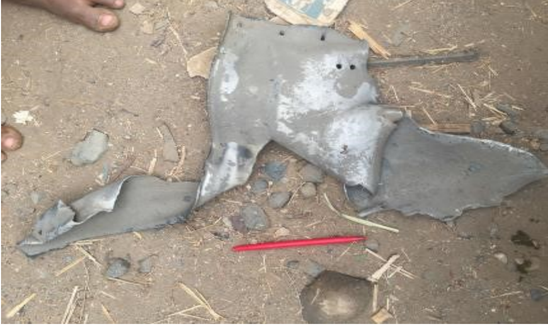
مخلفات "ستريك" (strake)، وهو جزء من قنبلة موجهة بالقمر الصناعي من نوع JDAM، وقُرتها الولايات المتحدة، عثر عليها في مسرح الغارة الجوية في 15 مارس/آذار 2016 على المستباء في شمال اليمن. © 2016 هيومن رايتس ووتش
